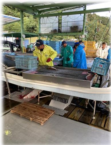
活け締めを選別風景。作業台の面に電気を流し、鯛を気絶させてから締める。
