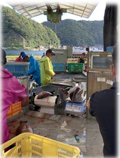
ベルトコンベアで流され、最後にサイズ選別
