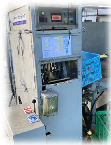
自動活け締め機。人力と活け締め機両方で一気に作業する。
