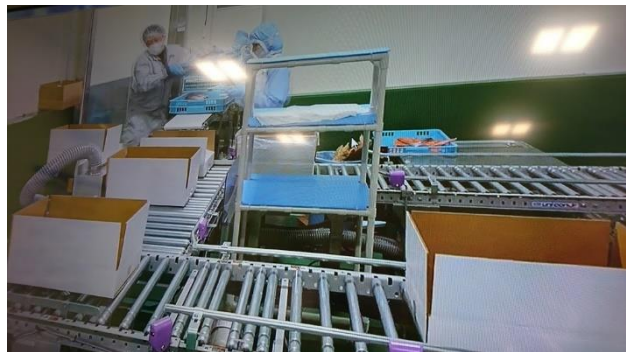
箱詰め 機械によって成形された段ボール箱に納めます。
