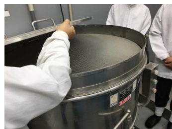
少量用の縦型混合機 500 L 200 k g 程度の生産に使用
