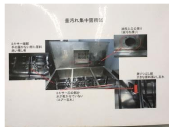
窯汚れ集中箇所図 洗浄時の注意用
