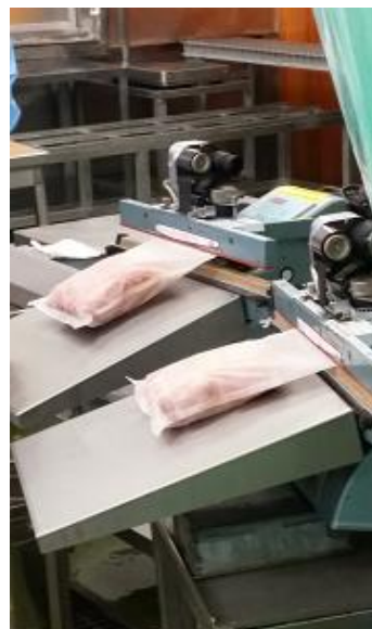
充填されたダシパックの上部を シールする。
