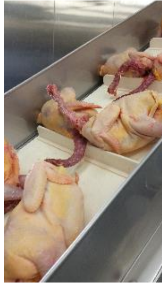
冷蔵庫設定0°C前後で冷却された原料をコンベヤーに投入する。
