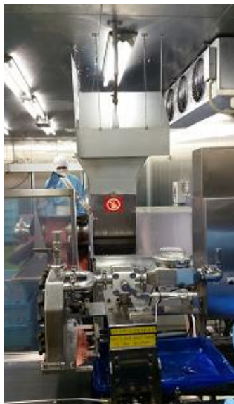
カナダPOSS社製のディボーンニングマシンPDE-2500を使用 ミンチとガラに分ける。
