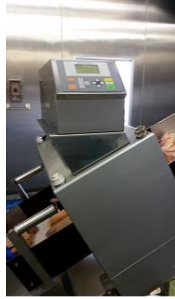
目視で原料の異物を確認しながら、金属検出器でのチェックもする。
