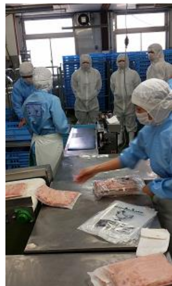
ダシパックを包装する。 成型された製品は冷凍トレーに 並べて、凍結庫-30℃設定で 12時間以上凍結される。
