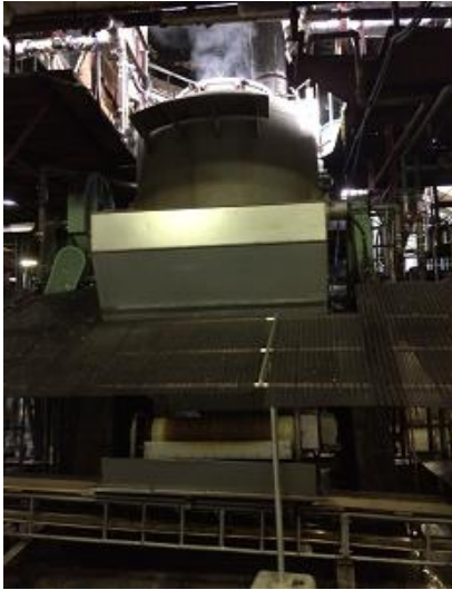
一晩水に浸した大豆を釜で蒸す(煮る) 同じ規模の釜が計3釜ある。
