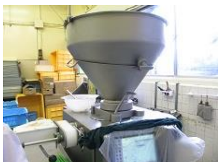
ケーシング充填機 ケーシングとはソーセージの皮のこと
