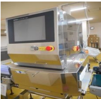
← ⑨X線探知機 (SuS球1.2セラミック球8.0)
