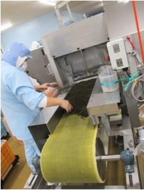
⑥乾燥→ 昆布の底面から温風が出ており混ぜながら乾燥させている。
